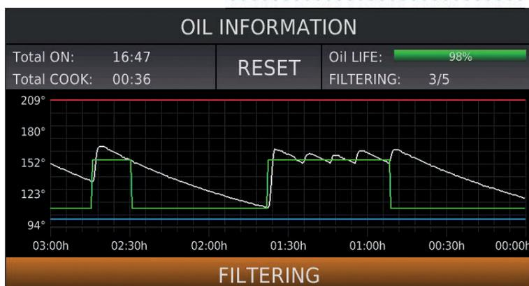
Le système de filtration entièrement intégré à l'intérieur de la friteuse permet de filtrer l'huile en moins de **4 minutes** et de revenir à la température réglée précédemment.
