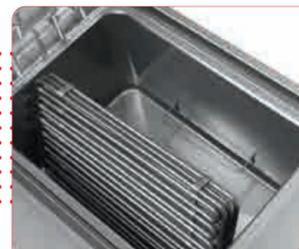
Vasca in acciaio inox AISI 304, stampata con ampie raggiature per evitare il deposito dei residui negli angoli. Resistenza ruotabile di 90° per facilitare la pulizia
