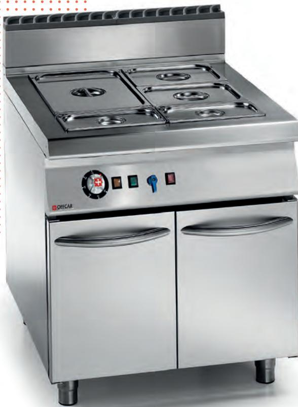
Il riscaldamento dei cibi avviene per conduzione da recipienti immersi in acqua calda. Piano di lavoro e vascastampata con ampie raggiature. L'assenza di elementi riscaldanti all'interno della vasca ne permette una facile pulizia. Carico acqua mediante erogatore interno alla vasca con elettrovalvola comandata da pulsante. Regolazione della temperatura da 30° a 90°C con spia luminosa che ne indica il funzionamento. Termostato di sicurezza contro la mancanza di acqua in vasca.
