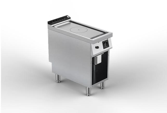
Tuttapiastra con piano di cottura radiante in acciaio legato spessore 15 mm con zone isothermiche differenziate, incassata al piano e circondata da canalina perimetrale a tenuta di liquidi con ampio foro di scarico e vaschetta di raccolta stampata GNI/3, facilmente asportabile per lo svuotamento e la pulizia.
