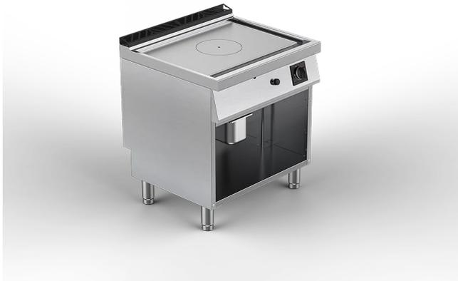
Tuttapiastro con piano di cottura radiante in acciaio legato spessore 15 mm con zone isothermiche differenziate, incassata al piano e circondata da canalina perimetrale a tenuta di liquidi con ampio foro di scarico e vaschetta di raccolta stampata GNI/3, facilmente asportabile per lo svuotamento e la pulizia.
