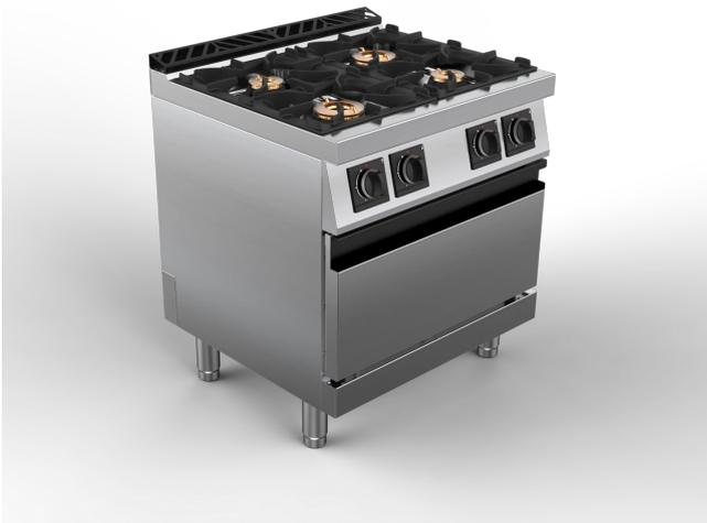
Piano di lavoro in acciaio inox AISI 304 spessore 2mm con finitura Scotch Brite. Cruscotto, pannelli laterali e schiena in acciaio inox AISI 304 spessore 1mm con finitura Scotch Brite.
