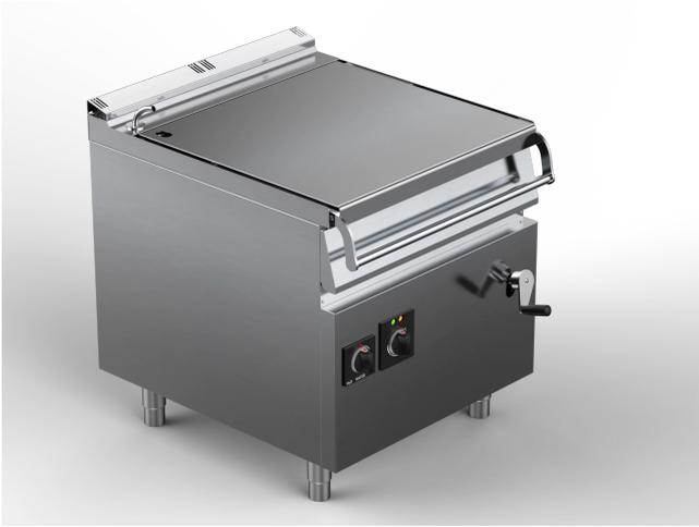
Vasca di cottura in acciaio inox AISI 304 con fondo spessore 10mm e pareti spessore 2mm. Ribaltamento manuale della vasca ottenuto mediante volantino in materiale atermico e vite senza fine, ribaltamento motorizzato sui modelli (BR ... M). Coperchio di chiusura in acciaio inox AISI 304 incernierato posteriormente e bilanciato a molla. Rubinetto carico acqua con erogatore orientabile.
