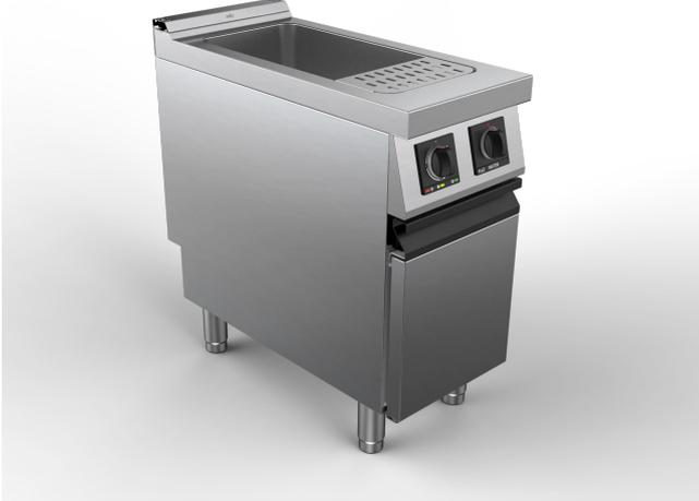
Vasca in acciaio inox AISI 316 priva di saldature, con angoli ampiamente raggiati ai fini di una più semplice ed efficace pulizia. Zona frontale con scivolo e piano forato per appoggio cestelli per la scolatura dell'acqua.
