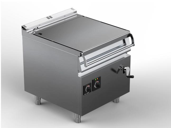
Vasca di cottura in acciaio inox AISI 304 con fondo spessore 12mm e pareti spessore 2mm. Ribaltamento manuale della vasca ottenuto mediante volantino in materiale atermico e vite senza fine, ribaltamento motorizzato sui modelli (BR ... M). Coperchio di chiusura in acciaio inox AISI 304 incernierato posteriormente e bilanciato a molla. Rubinetto carico acqua con erogatore orientabile.
