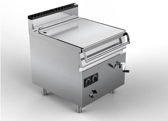
Vasca di cottura in acciaio inox AISI 304 con fondo spessore 12mm e pareti spessore 2mm. Ribaltamento manuale della vasca ottenuto mediante volantino in materiale atermico e vite senza fine, ribaltamento motorizzato sui modelli (BR ... M). Coperchio di chiusura in acciaio inox AISI 304 incernierato posteriormente e bilanciato a molla. Rubinetto carico acqua con erogatore orientabile.
