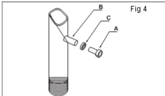
La presión del gas de alimentación debe medirse a la altura de la toma de presión (Fig. 4)-( Ref. B) tras haber quitado el tornillo (Ref. A). Conectara la toma de presión un medidor por medio de un tubo flexible (por ejemplo, un manómetro líquido, con una resolución mínima de 0,1mbar) y medir la presión a la entrada mientras funcione el aparato. Si el valor de la presión no está comprendido dentro de los límites inferior y superior que se indican en la tabla, no se podrá instalar el aparato.
