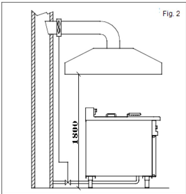
Quand l'appareil est installé sous une hotte aspirante, il faut vérifier que les indications suivantes sont respectées:
