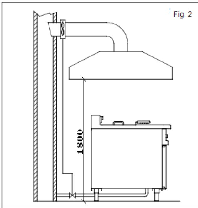
Cuando el aparato se instala bajo una campanaextractora hay que comprobar que se respeten las siguientes indicaciones:
