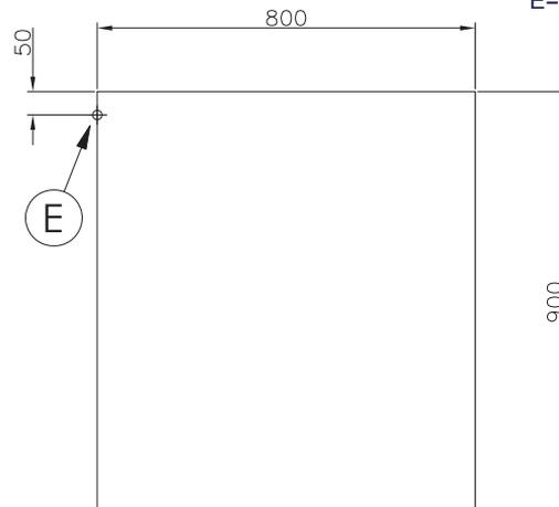
E= RACCORDEMENT ÉLECTRIQUE
